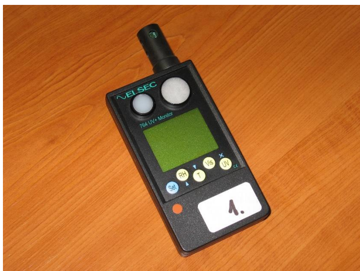
35. kép Hőmérséklet, relatív páratartalom, látható- és UV-fény mérésére alkalmas hordozható, adatgyűjtős műszer
